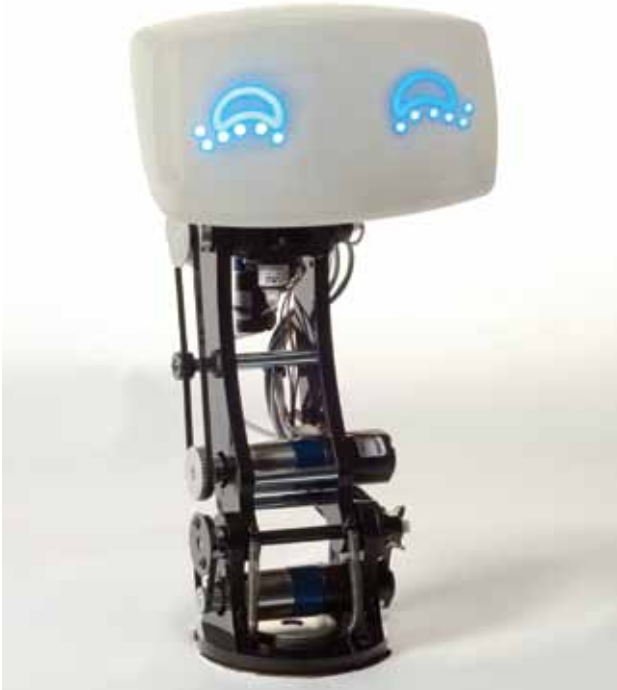
Figuur 3 ● AIDA (Affective, Intelligent Driving Agent) houdt rekening met de wensen van de bestuurder. Bron: AIDA MIT/Volkswagen.
